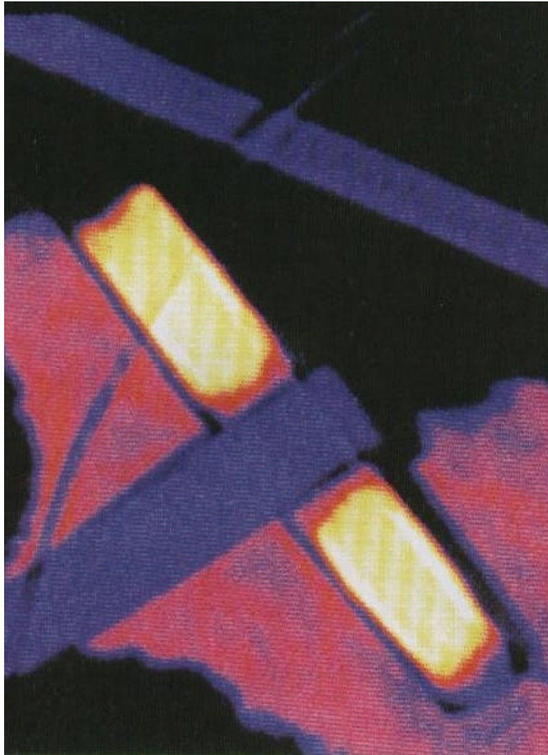
Das Röntgenbild des Hammerkopfes zeigt eine homogene Struktur des Stahls als Falschfarbenfoto. Foto: © Hefenstine / Zillmer
